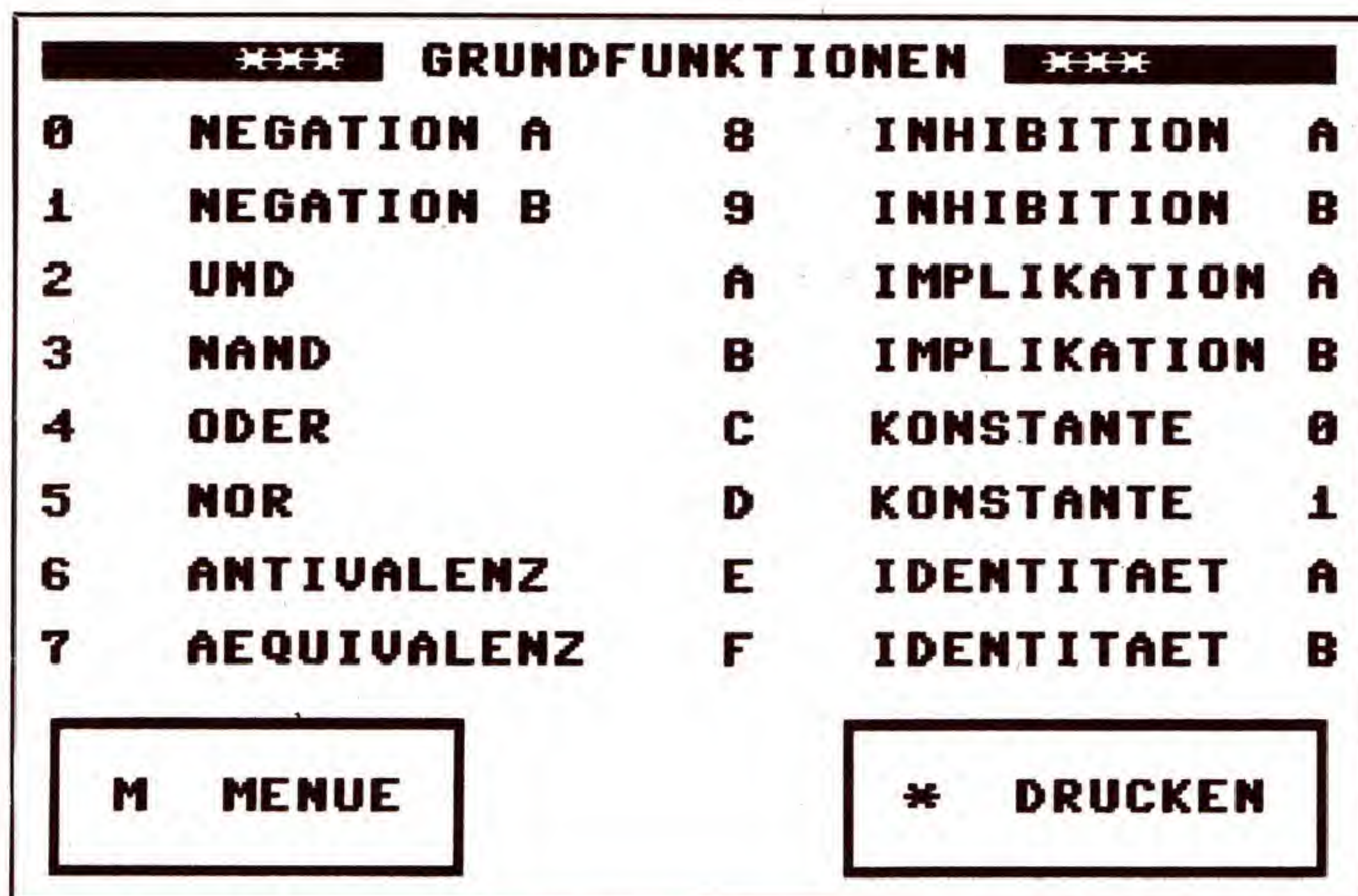
Bild 2. Alle 16 möglichen logischen Gatterschaltungen bei Digitalgliedern mit bis zu zwei Eingängen
